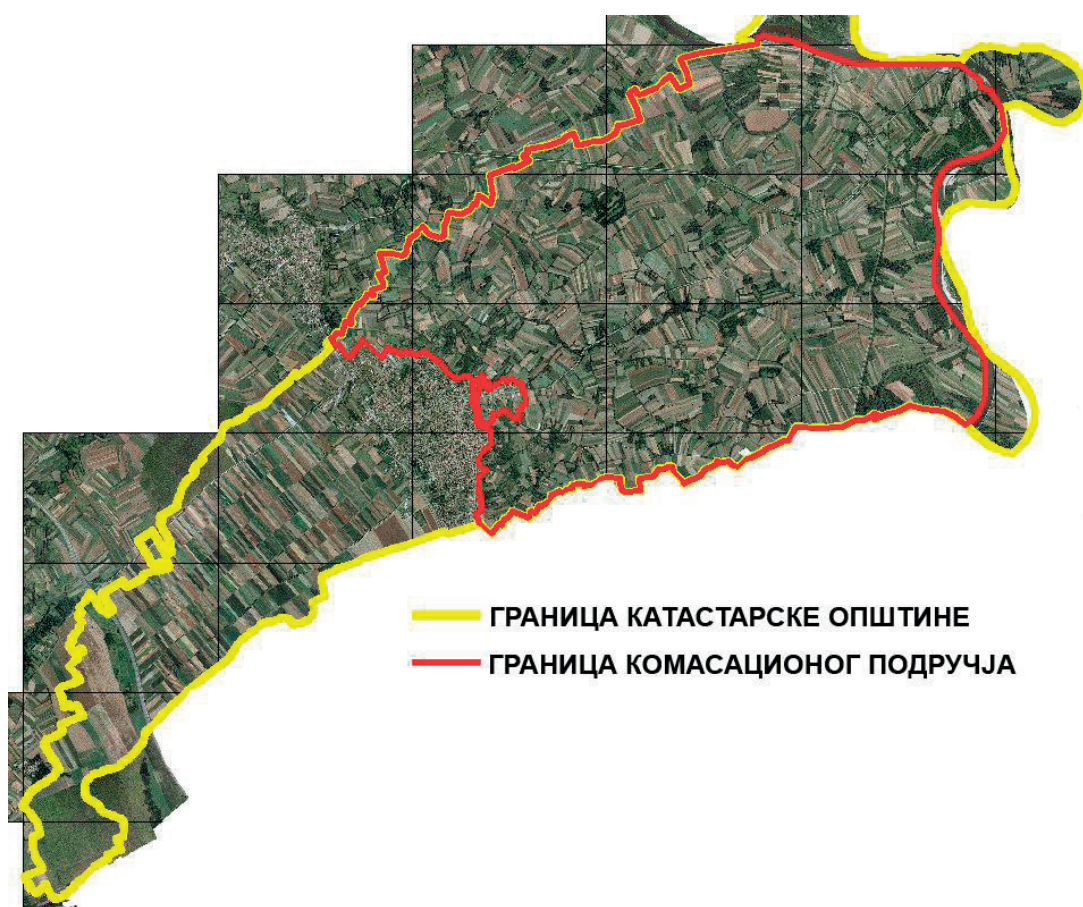
Слика 1. Комасационо подручје на основи ортофото плана
