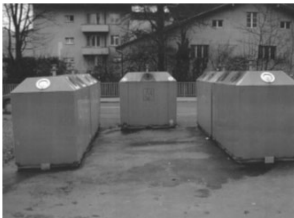
Слика 9: Савремени контејнери за сакупљање и селектовање стаклене амбалаже према боји стакла
