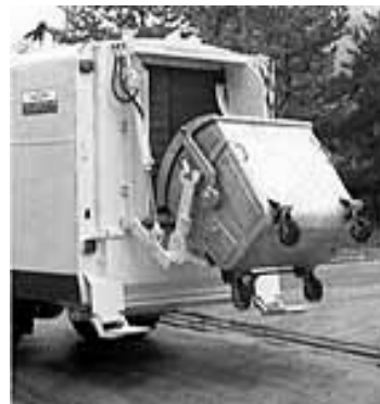
Слика 15: Аутосмећар ФАП 1317/36 (контејнер запремине 1,1 м 3 )
