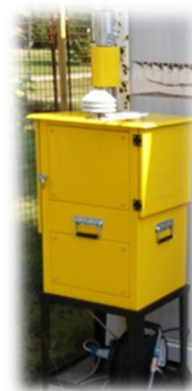
Слика 7. Изглед узоркивача LIFETEK PMS
