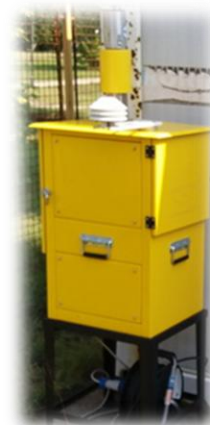
Слика 7. Изглед узоркивача LIFETEK PMS
